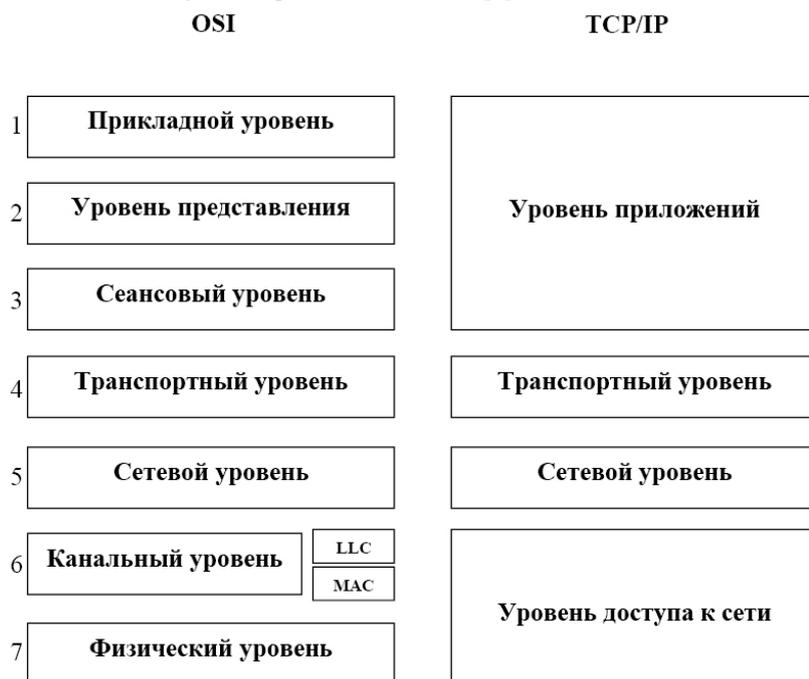
Рисунок 2 – Сравнение моделей TCP/IP и OSI
