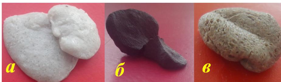
а – крошки мела, б – угольный отсев и в – строительный песок
