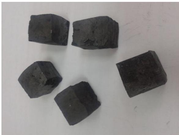
Рисунок 2 – Углеродные огнеупоры прошедшие механическую обработку. Размеры образцов  $\sim 2 \times 2$  см
