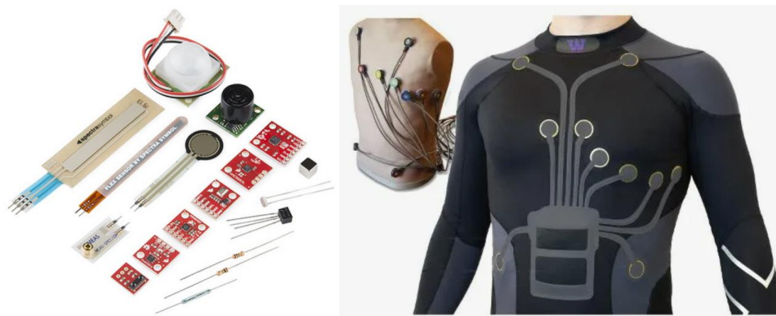
Рисунок 4 – Набор датчиков SensorsKit (движения, скорости, расстояния и т.д.) для умной одежды (взято из источника: https://www.electan.com/sensor-kit-amp-3526.html )
